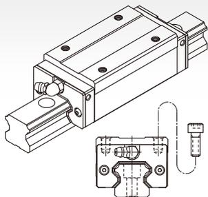
与MSA-S型具有相同断面尺寸，增加滑块的长度，并增加负荷钢珠数，提升整体的负荷能力。
